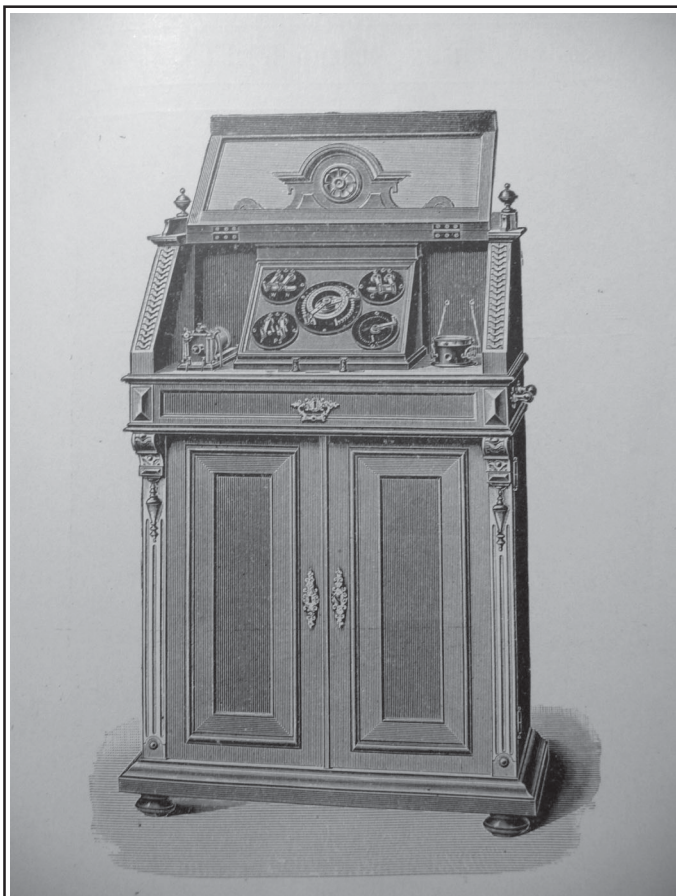
Figure 5 : Galvanisation : appareil intégré dans un meuble de salon.
